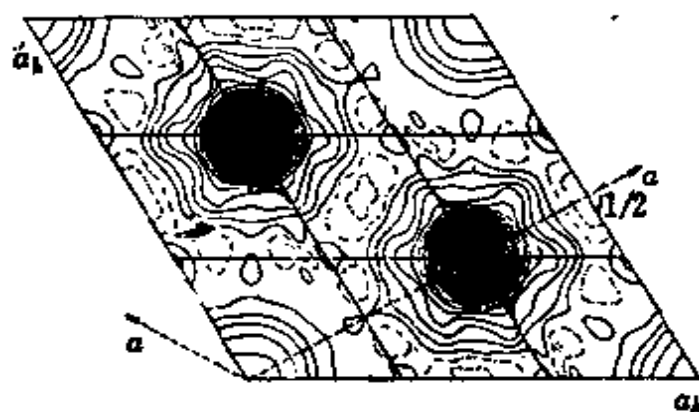
图 10.15 修正后的 I \propto F^2 关系的二维电势分布图 [17] , \text{Ni}_3\text{C} [001]方向
